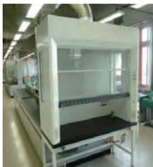
写真3：車いす対応実験台(排気設備付き)
