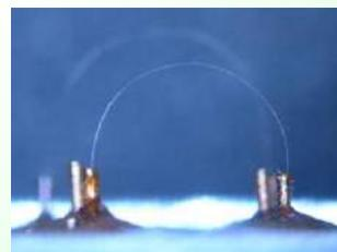
極微細超伝導線（NbTi 直径1～3 μm）
