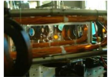
図1: レーザー冷却されたカリウム原子(中央のオレンジの輝点)
